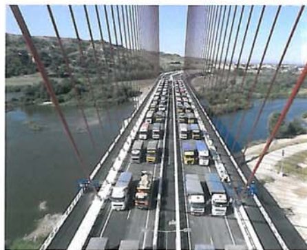
Figura 45. Fase de máxima carga en la prueba de carga Figure 45. Maximum load stage during load trial
