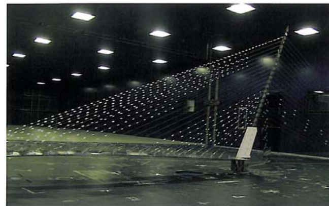
Figura 32. Maqueta para el modelo de túnel de viento en el Politécnico de Milán Figure 32. Polytechnic University of Milan wind tunnel model
